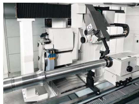
Eixo do gerador / Eje de generador
